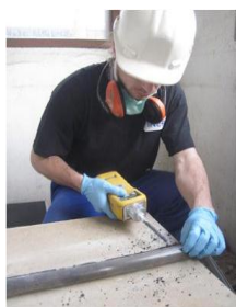
FIGURE 43 : PROFIL DES MESURES PID OBTENU SUR UNE CAROTTE DE SOL (SITE ATELIER FLUXOBAT)
