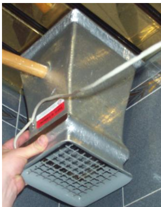
FIGURE 28 : MESURE DES DEBITS DES EXTRACTIONS D'AIR DU BATIMENT
