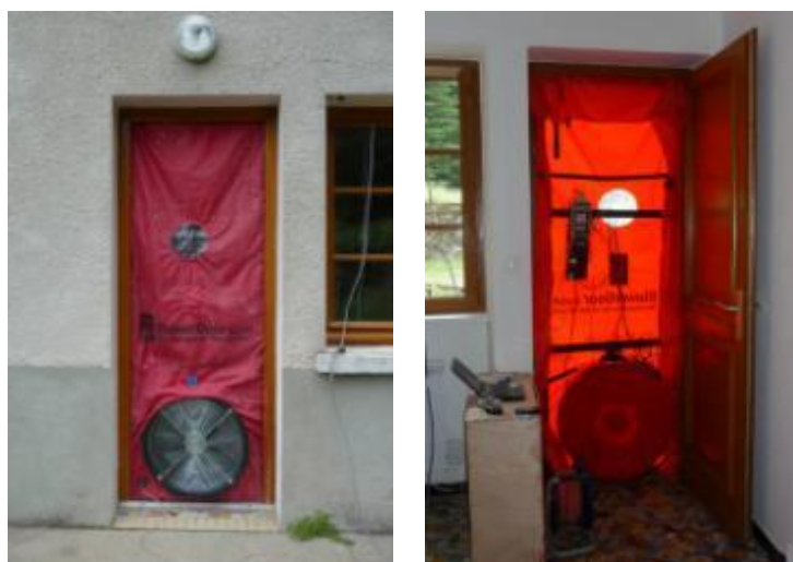
FIGURE 27 : ILLUSTRATION DE FAUSSE PORTE INSTALLEE POUR LA MESURE DE LA PERMEABILITE DE L'ENVELOPPE DU BATIMENT
