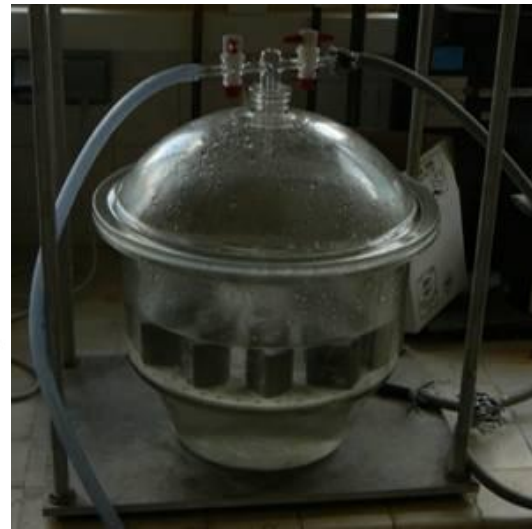
FIGURE 19 : SCHEMA DU DISPOSITIF EXPERIMENTAL UTILISE POUR LA MESURE DE LA POROSITE A L'EAU DES BETONS
