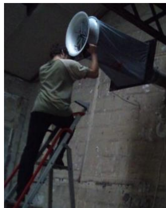
FIGURE 28 : MESURE DES DEBITS DES EXTRACTIONS D'AIR DU BATIMENT
